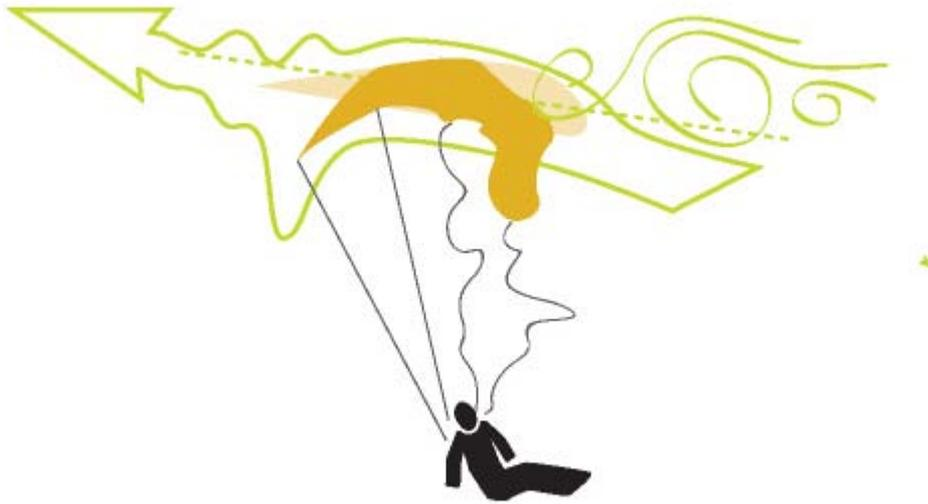
Quer isto dizer que o seu perfil e a sua forma geral se podem deformar sempre que o ângulo de incidência do fluxo de ar, parcial ou não, seja negativo, produzindo o chamado fechamento.
